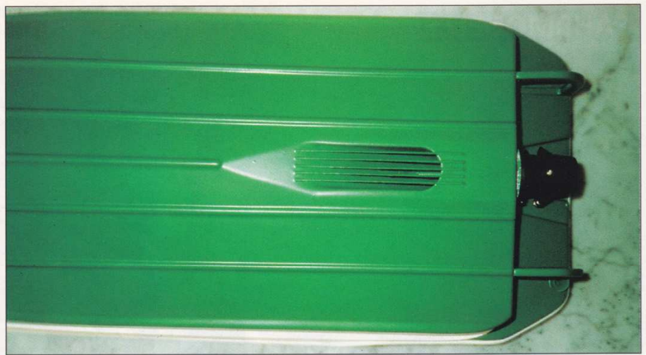
Die Öffnung im Rumpfboden für den Jet-Antrieb.
